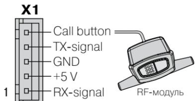
Удлинение кабеля RF-модуля
