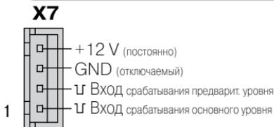
Входы отрабатывают импульсы отрицательной полярности длительностью не менее 0,3 сек
