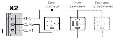
Использовать только для версии с дистанционным стартом двигателя (на выводе «3» +12V присутствует постоянно)
