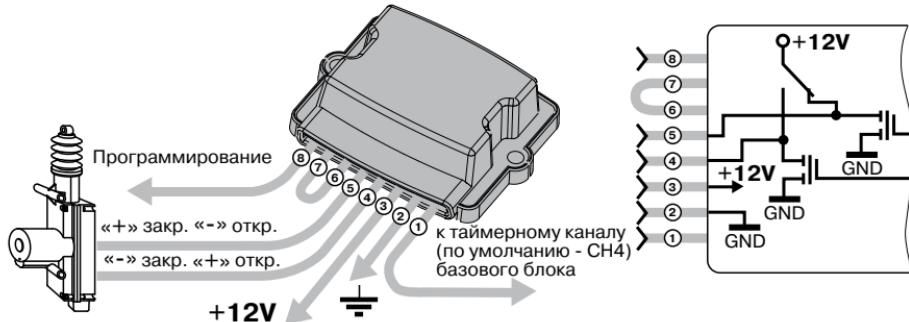
В системе **Pandora DeLuxe** режимы «Поддержка зажигания», «Программная нейтраль», «Турботаймер» организованы штатным образом с использованием «реле поддержки зажигания и блокировки» (CH5), но для реализации этих режимов можно использовать любой другой таймерный канал. Способ подключения данного реле («С разрывом» или «Параллельно») может быть выбран п. I-10.6 меню программирования.
