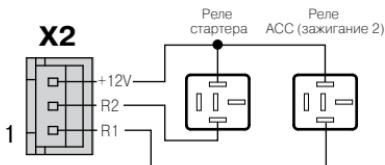
Использовать только для версии с дистанционным стартом двигателя (на выводе «3» +12V присутствует постоянно)
