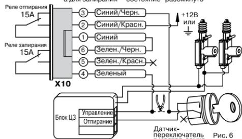
Схема подключения к блоку ЦЗ где для запирания требуется напряжение +12В, а для отпирания +5В : FORD PROBE (MAZDA 626)
