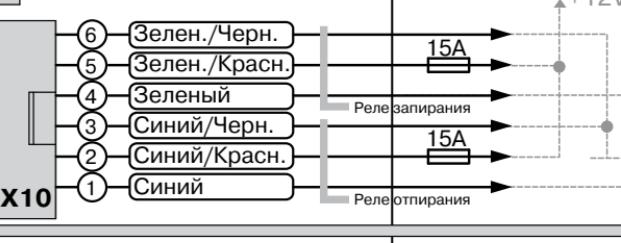
Схема подключения автосигнализации
