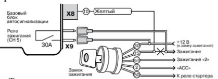
Схема подключения параллельно замку зажигания
