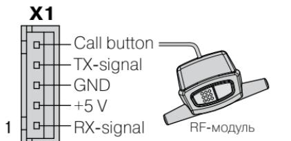
Удлинение кабеля RF-модуля в большинстве случаев не допускается
