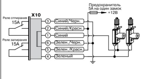
Схема подключения 2-проводных дверных замков для двухступенчатого открывания дверей
