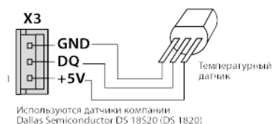
Подключение датчиков температуры
