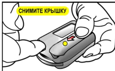
Для замены батареи питания откройте крышку батарейного отсека с обратной стороны пульта, как показано на рисунке – сдвинув крышку в сторону кольца для ключей. Выньте старый элемент, затем вставьте новый, соблюдая полярность подключения. Закройте крышку в обратной последовательности.
