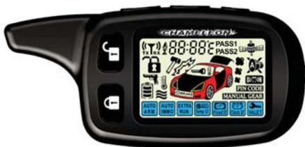
Двусторонний пульт представляет собой миниатюрное приемно-передающее устройство с питанием от 1,5 вольтовой батарейки (тип LR03 AAA), которой, в зависимости от интенсивности использования пульта, хватает на срок от 1 до 6 месяцев. При установке свежей батареи индикатор её заряда
