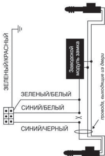
Схема 5. Однопроводный тип цепи дверных замков с оприцательной полярностью (некоторые автомобили марки Ниссан, Mazda и др.)
