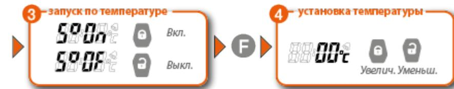
Режим позволяет автоматически запускать двигатель по его температуре и будет действовать, если в установках брелока (меню «START») режим будет включен и выставлена температура запуска.
